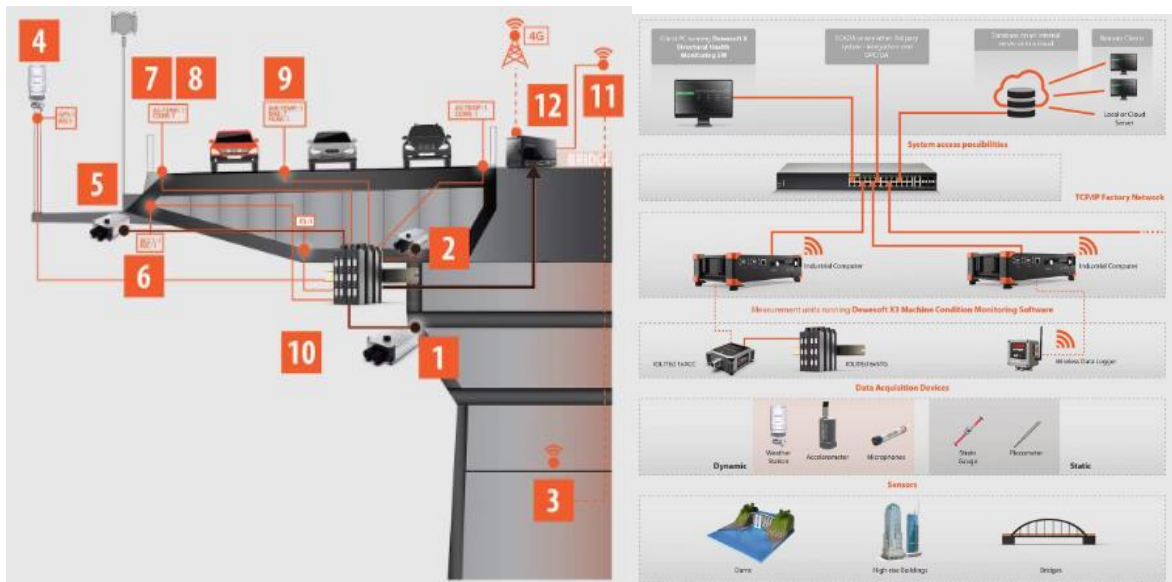
Рисунок 1 – Размещение датчиков на мосту и приборы дистанционного мониторинга
